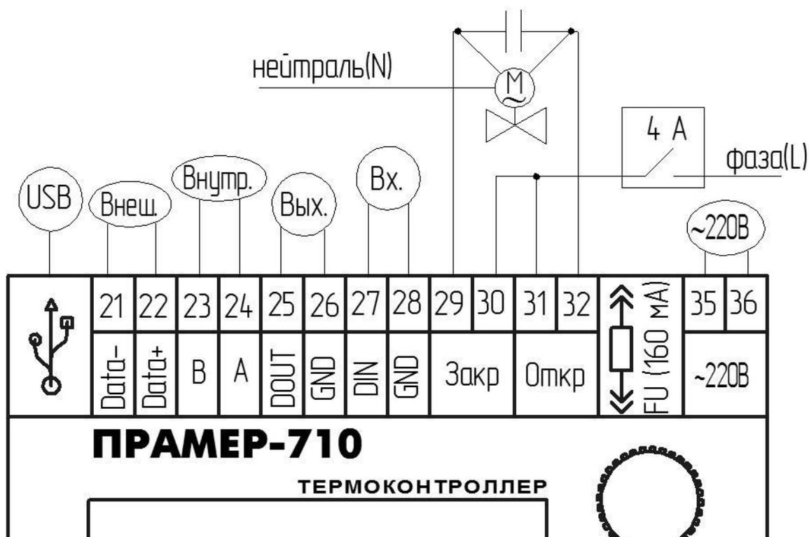
Рисунок 2 – Назначение клемм подключения внешних устройств
